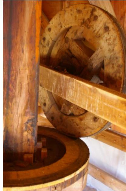
Mit einem auf dem Steinboden endenden Seil wird über einen Hebel bei laufender Mühle das Schleifrad auf das drehende Storchennest abgesenkt. Dadurch wird das Seil aufgewickelt und der Getreidesack über die nach oben hin sich öffnenden Bodenklappen auf den Steinboden angehoben.
